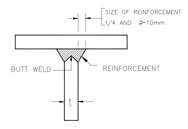
BUTT WELDED T JOINT
